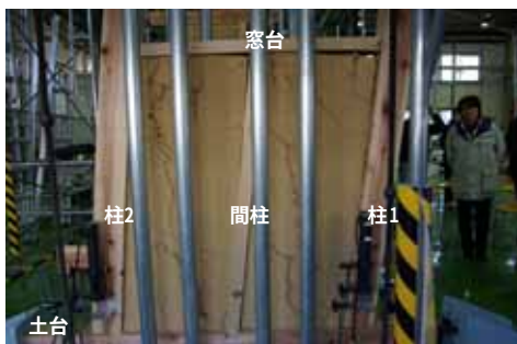
図I_15 裏返し側 最終加力時1/10rad 腰壁せん断ひび割れ
