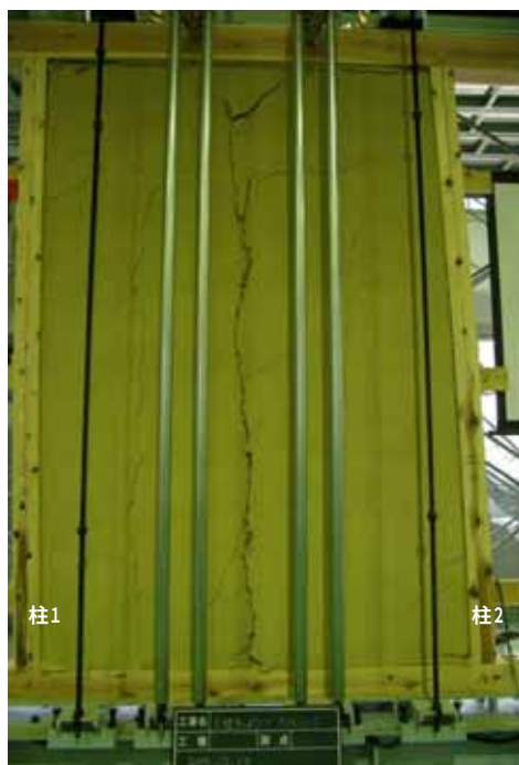
図I.8 中塗側 1/30rad 間柱のひび割れ拡大、貫のこじり効果により壁土が面外に膨らむ
