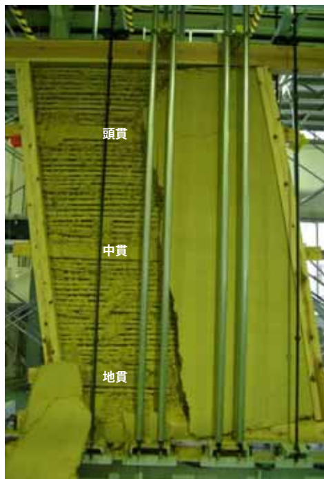
図I.11 中塗側 1/7.5rad 中塗面壁土の崩落
