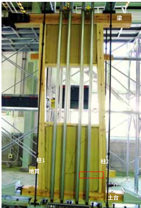
図I.11 中塗側 最終加力時1/30rad せん断ひび割れ拡大、地貫のこじり効果によるひび割れ
