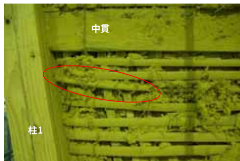
図I.10 中塗側 1/7.5rad 間渡し竹のダボ的效果壁土が存在することによって生ずる
