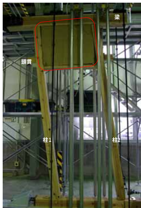
図M_14 中塗り側 最終加力時1/8.6rad ひび割れ拡大
