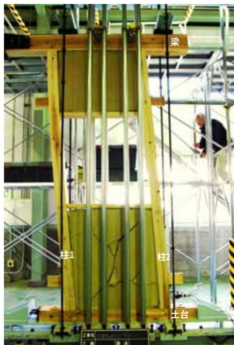
図I.12 中塗側 最終加力時1/15rad ひび割れ拡大
