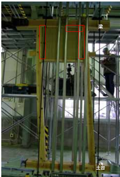
図M_6 中塗り側 1/15rad ひび割れの拡大
