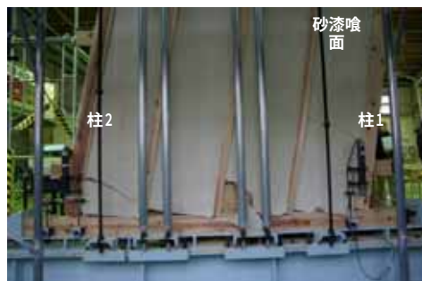
図I.14 砂漆喰側 1/7.5rad せん断ひび割れ
