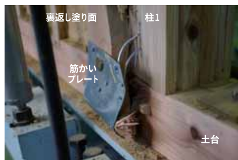
図 K_11 試験終了後 柱1側 筋かいの脱落と筋かいプレートの変形
