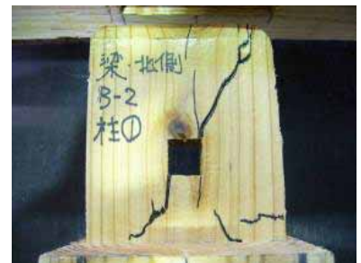
写真2.1 接合部破損状況
