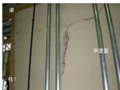
图 F-1.7 中塗側 最終引込
