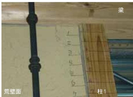
图 B-3.1 荒壁側 1/150rad
