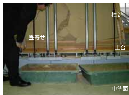
図 G.7 中塗側 最終加力
