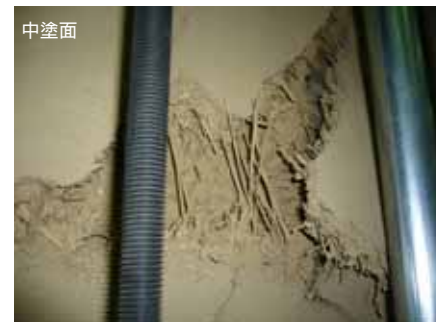
図 D_8 中塗側 最終加力
