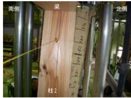
図 E_6 中塗(北)側 最終加力
