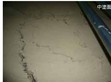
図 D_6 中塗側 最終加力
