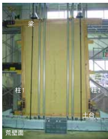
图 B-3.5 荒壁側 1/50rad
