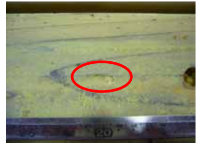
写真 4.3.5 割り竹の軸組へのめり込み
