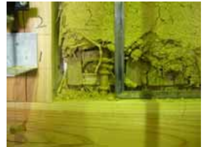
写真 4.3.2 柱-土台隅角部の圧縮
