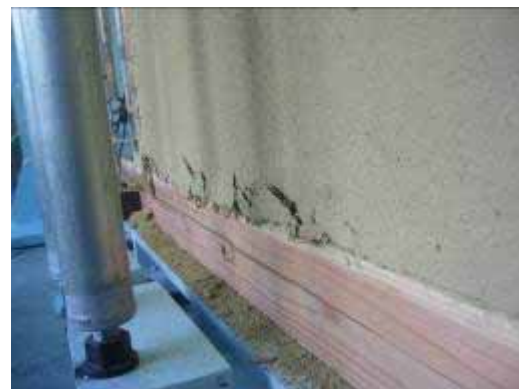
写真 3.3.8 B-2 中塗り剥落直前
