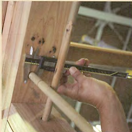
▲ 試験体 A (告示型) は間渡し竹の元は 18mm 近くになる
