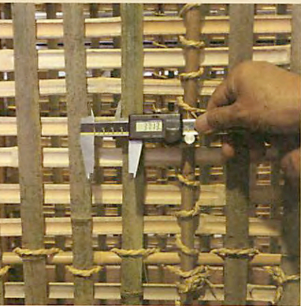
▲ 試験体 B (地域型) は割竹の間は約 37mm
