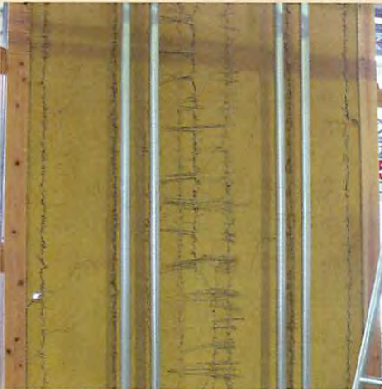
▲ 間渡し竹部分等塗り厚が薄い箇所は壊れやすくなる
